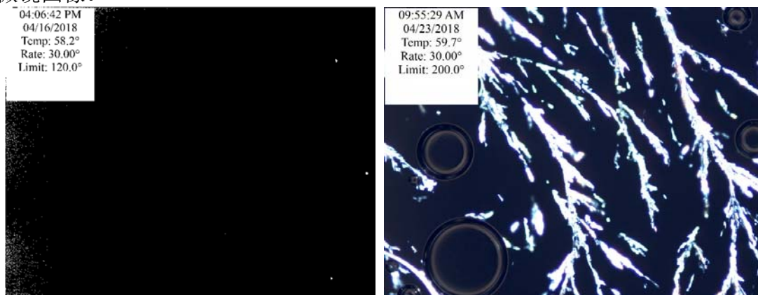
图2.浓度为 375 mg/g (左)和 400 mg/g (右)的布洛芬热台显微镜图像 ( 59° C)
